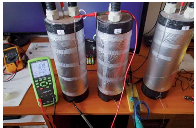
Obr. 12 Skúšobné vzorky na meranie odporu injektážnej malty a kapacity oproti okolitému betónu (simulovaný Al fóliou)
