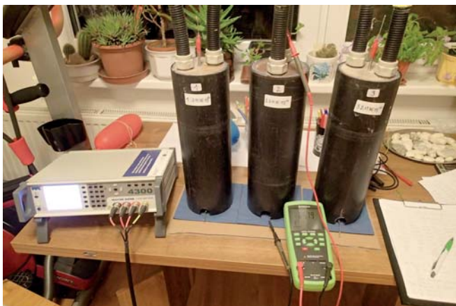
Obr. 12 Skúšobné vzorky na meranie odporu injektážnej malty a kapacity oproti okolitému betónu (simulovaný Al fóliou)
