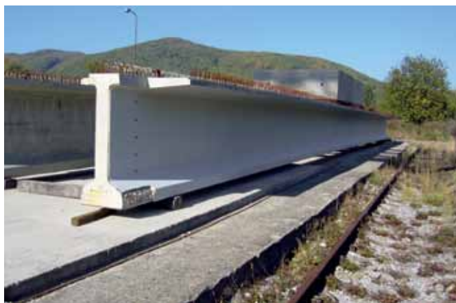
Obr. 6 a 7 Nosníky IST-EN/08 na skládke v závode Prefa Kysak
