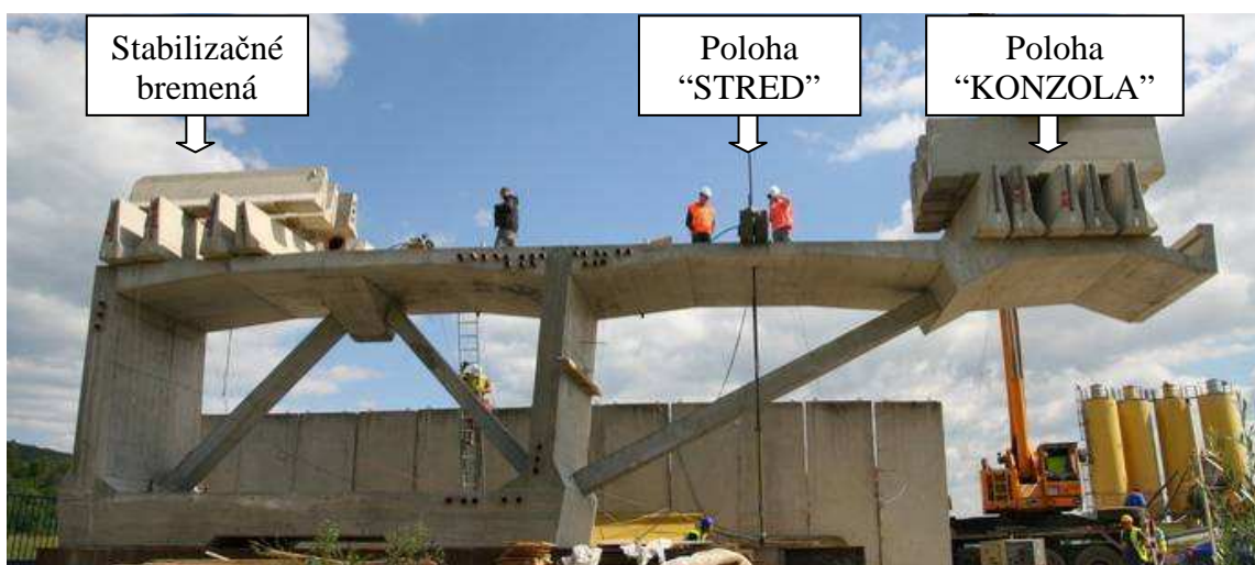
Obr. 7 Lamela s maximálnym zaťažením konzoly
