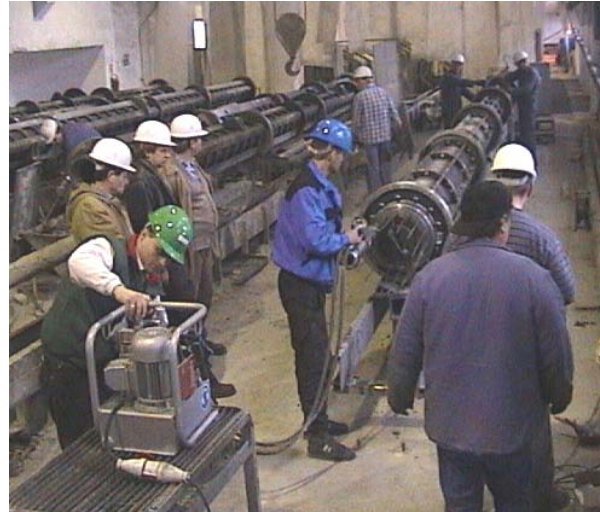
Obr. 4 Napínanie drôtov lisom PAUL TENZA SM 200 kN
