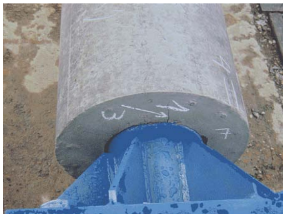
Obr. 7. Trhlinka v kotvení
