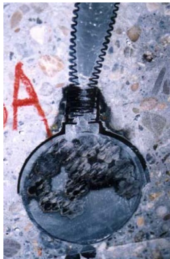
Obr.5 Skúška injektovateľnosti kábla. Geometria skúšobnej vzorky, kontrola kompaktности zatvrdnutej injektážnej malty.
