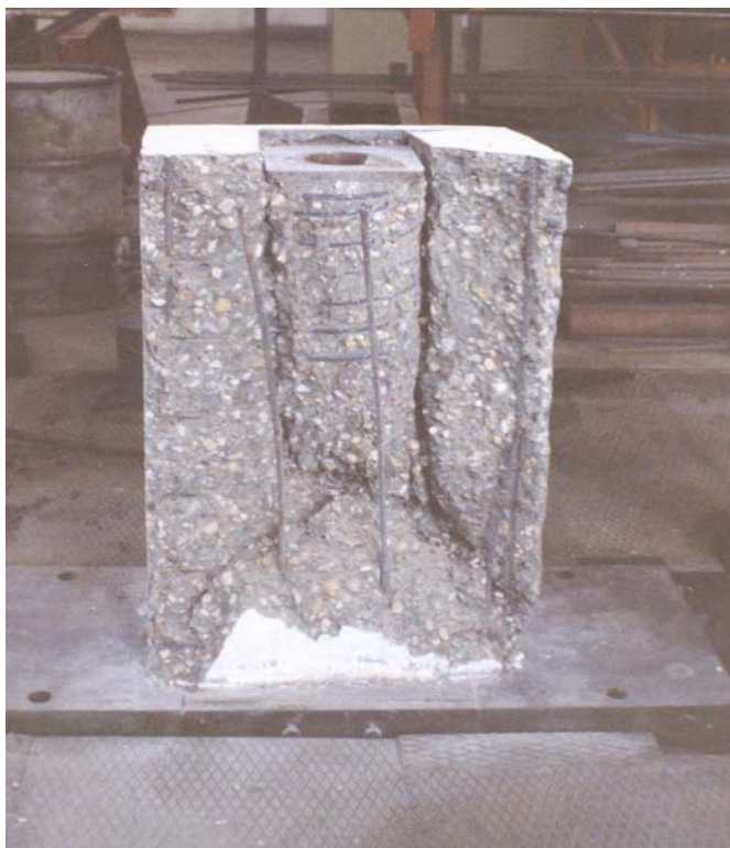
Obr.3 Skúška prenosu zaťaženia od 13 lanovej kotvy – porušenie vzorky
